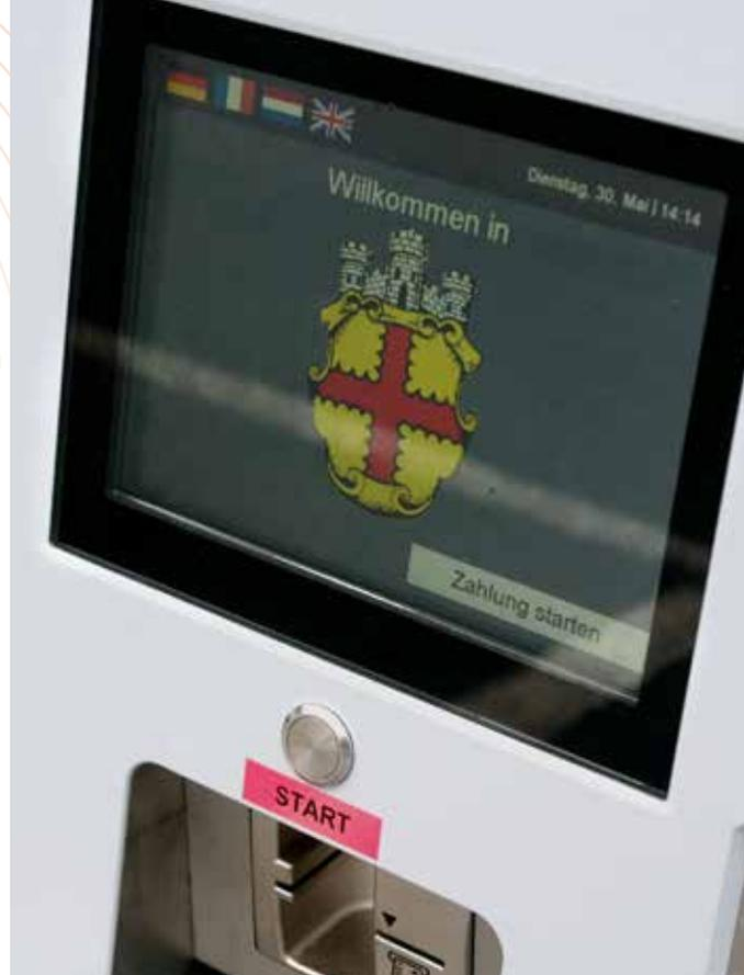
leranfälligkeit installiert: Die Bedienung der Automaten erfolgt via Touchscreen und ist in deutscher, französischer, niederländischer und englischer Sprache möglich. Der Nutzer folgt schrittweise den Angaben auf dem Bildschirm und erhält sein Parkticket binnen weniger Augenblicke.
