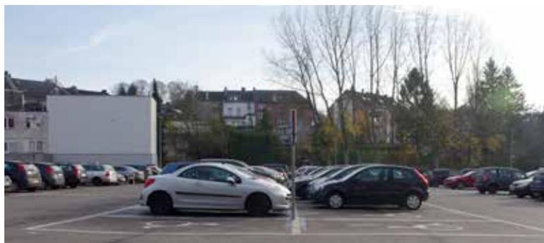
5 Meter Länge und in direkter Straßennähe 2,50 Meter Breite mal 6 Meter Länge – situationsbedingte Normabweichungen sind möglich. In allen Fällen sollte ausreichend Rangierfläche neben bzw. hinter dem Fahrzeug gewährleistet sein.
