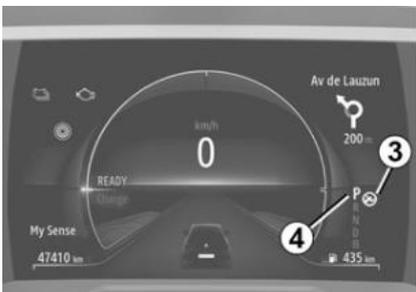
Beim Verlassen der Position P muss vor dem Drücken des Entriegelungsknopfes (2) das Bremspedal betätigt werden.
