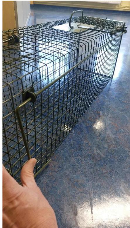
9. Afin de maintenir le piège ouvert, pousser le crochet du support d'appât sous la barre.
